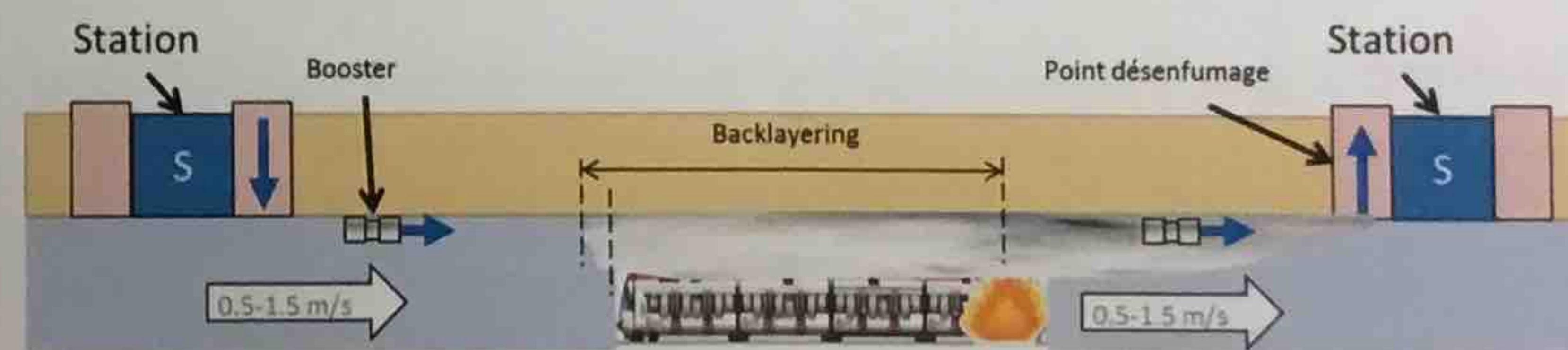
Figuur 7 : Schematische illustratie van de functies van het rookafzuigstelsysteem
