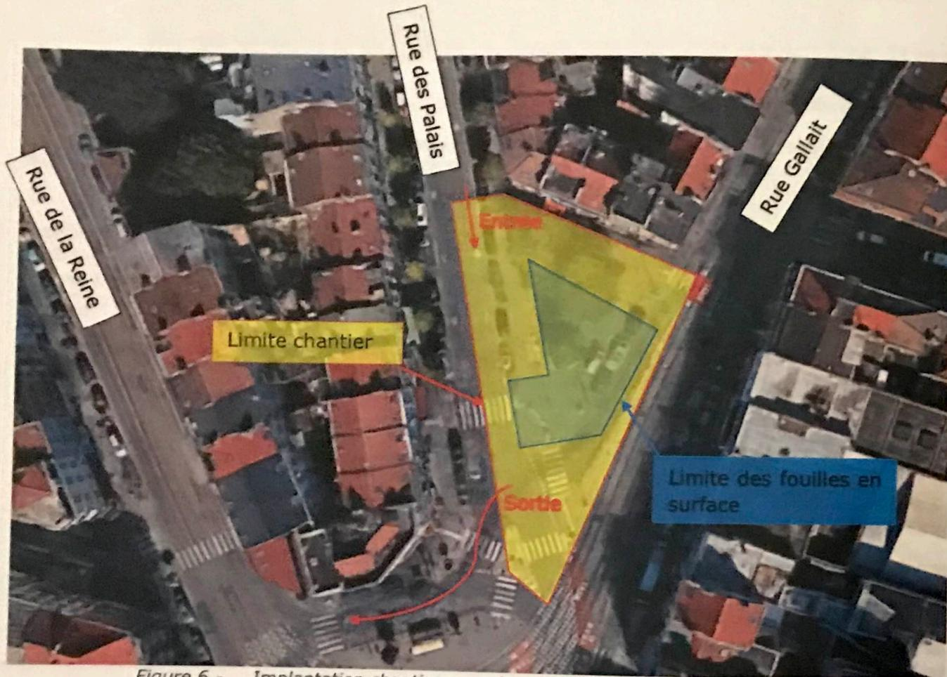
Figure 6 - Implantation chantier, emprise chantier, accès et exutoires
